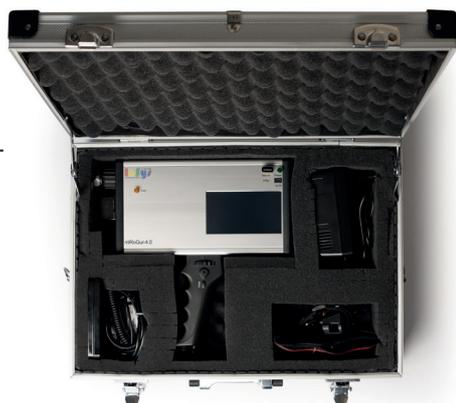
Zur Kunststoffidentifikation wird die Messpistole einfach auf das zu untersuchende Material gehalten und die Messung durch Betätigen einer der Triggertasten ausgelöst. Hierbei können Einzelmessungen wie auch fortlaufende Messungen mit festgestellter Triggertaste – z.B. von gemischten Granulaten – durchgeführt werden.
