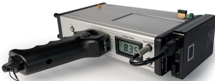
Das Gerät verfügt über Energiesparmodi in verschiedenen Stufen, so daß die Batterie-Laufzeit über einen Tag beträgt, welche mit einer an der Rückseite fixierbaren PowerBank noch verlängert werden kann. Ein im Griff integrierter Touchpen ermöglicht auch die Eingabe von Kommentaren und Zeichnungen für den Ausdruck der Messprotokolle, welche mit dem individuellen Firmenlogo des Anwenders gestaltet werden können.
