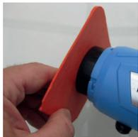
Das Prinzip der Methode ist eine kurzzeitige thermische Verdampfung eines kleinen Teiles der Kunststoffoberfläche mit Hilfe von stromstarken Gleitfunken definierter Entladecharakteristik. Hierbei werden die Bestandteile des Materials in der Funkenstrecke schlagartig verdampft, ionisiert und zur Aussendung von Lichtstrahlung angeregt.
