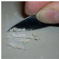
Mit der innovativen Technik der sogenannten Gleitfunken-Spektrometrie ist es möglich, handhabbare, kompakte, elektrisch nichtleitende Kunststoffteile aus dem Haushalts- und dem Elektro-/Elektronikbereich oder andere nichtleitende Materialien direkt zu untersuchen. Stark verschmutzte oder lackierte Messstellen können zur Reinigung einfach mit einem Messer freigekratzt werden.
